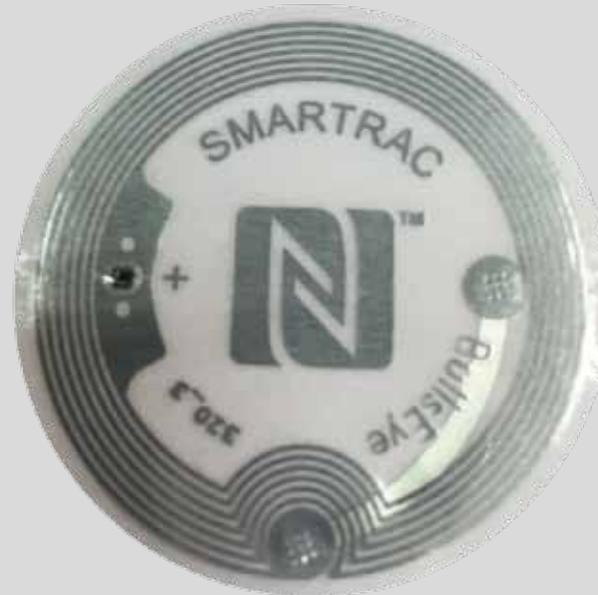
Sistema SMART TAG di tracciabilità del controllo qualità e gestione delle attività di manutenzione in servizio
