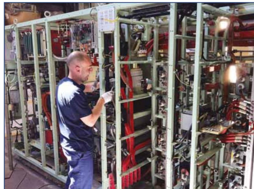
Revamping convertitore di trazione E402 con sostituzione Moduli da GTO ad IGBT
